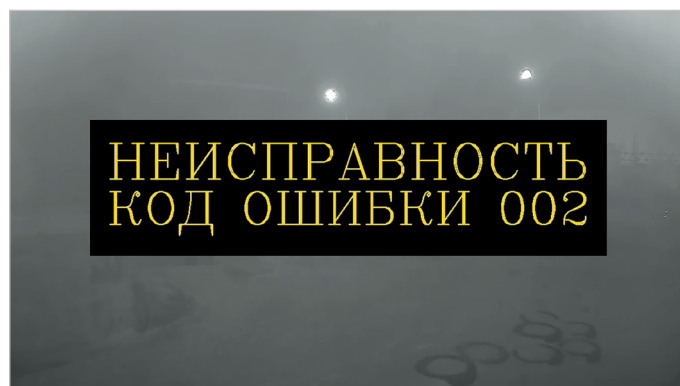
Рисунок 12. Неисправность извещателя по перекрытию поля зрения видеокамеры.
