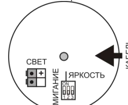
Рисунок 5 – Расположение клеммников и микропереключателей в коммутационном отсеке оповещателя «Плазма»П-С-40х20
