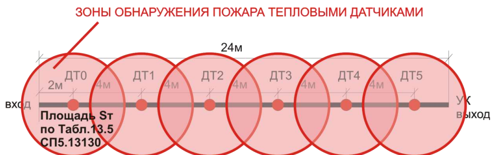
Рис.1.7. Зона мониторинга тепловыми датчиками КХ ProCab® ИП101-1-Р-МТ.
