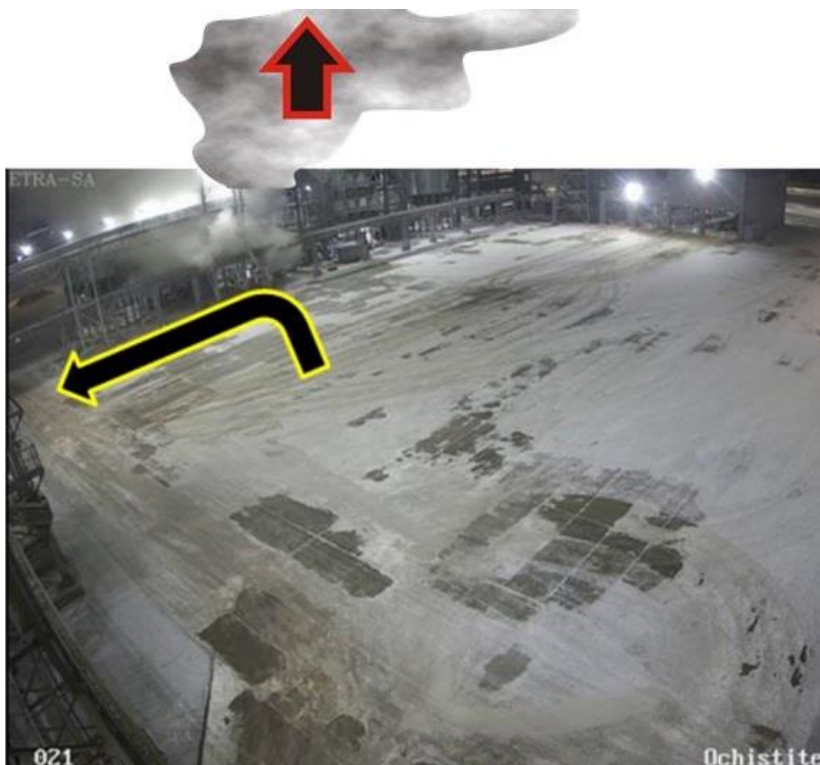
Рисунок 44 – Неудачное расположение видеосенсора. Распространение дыма вверх обрезано видеокамерой. По видеопоследовательности движение дыма выглядит так, что основной поток дыма направлен вниз и поэтому дым игнорируется алгоритмом ИПВ.
