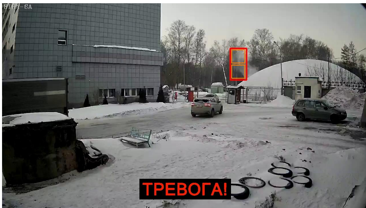
Рисунок 21 – Обнаружение пожара на расстоянии 73 метра.
