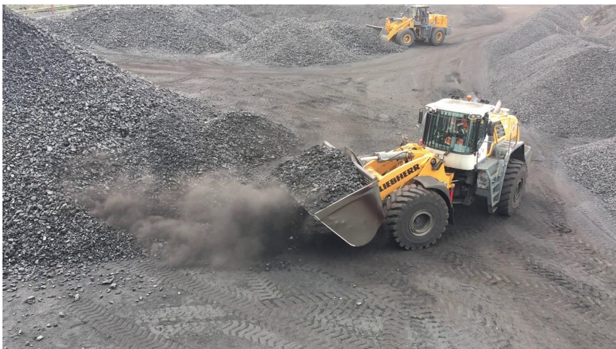
Рисунок 38 – ИПВ должен определять горение угля в угольном складе. Горение угля будет сопровождаться дымом белого цвета. Настройки ИПВ отсекают срабатывание по тёмным ветровым взвесам угольной пыли.
