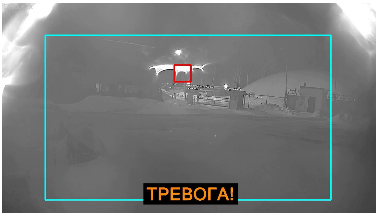
Рисунок 40 – Ложное срабатывание, вызванное каплями на объективе ВС.
