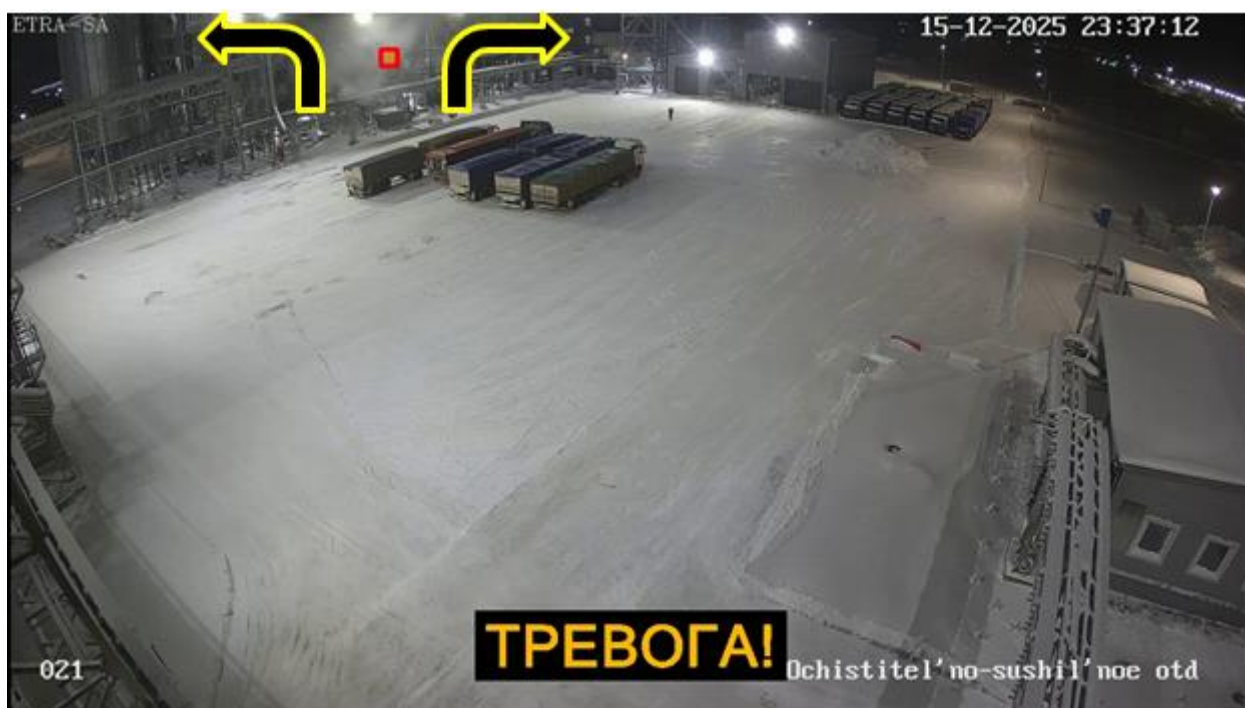
Рисунок 45 – Несмотря на неудачное расположение видеосенсора, в видеопоследовательности основные потоки дыма направлены вверх и влево-вправо. Поэтому дым был обнаружен алгоритмом ИПВ.
