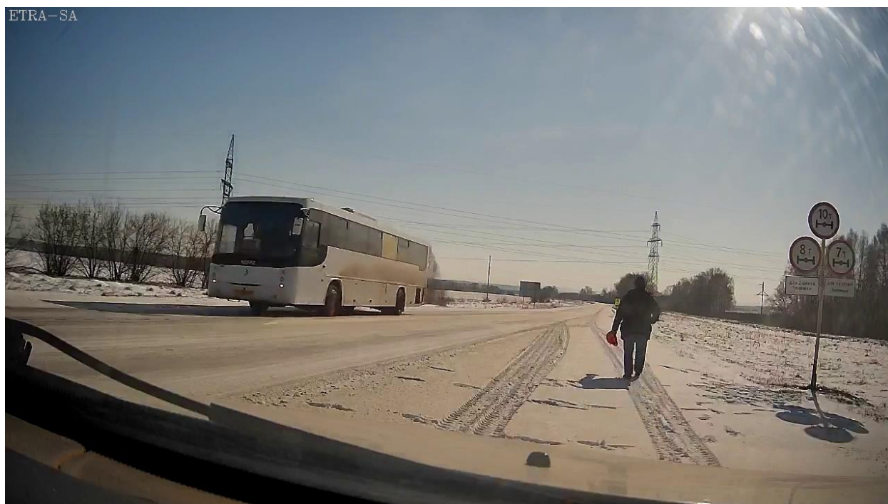
Рисунок 32 – Видеосенсор установлен в стоящем автомобиле. Нет фактов срабатывания на проезжающий автотранспорт и идущего человека.
