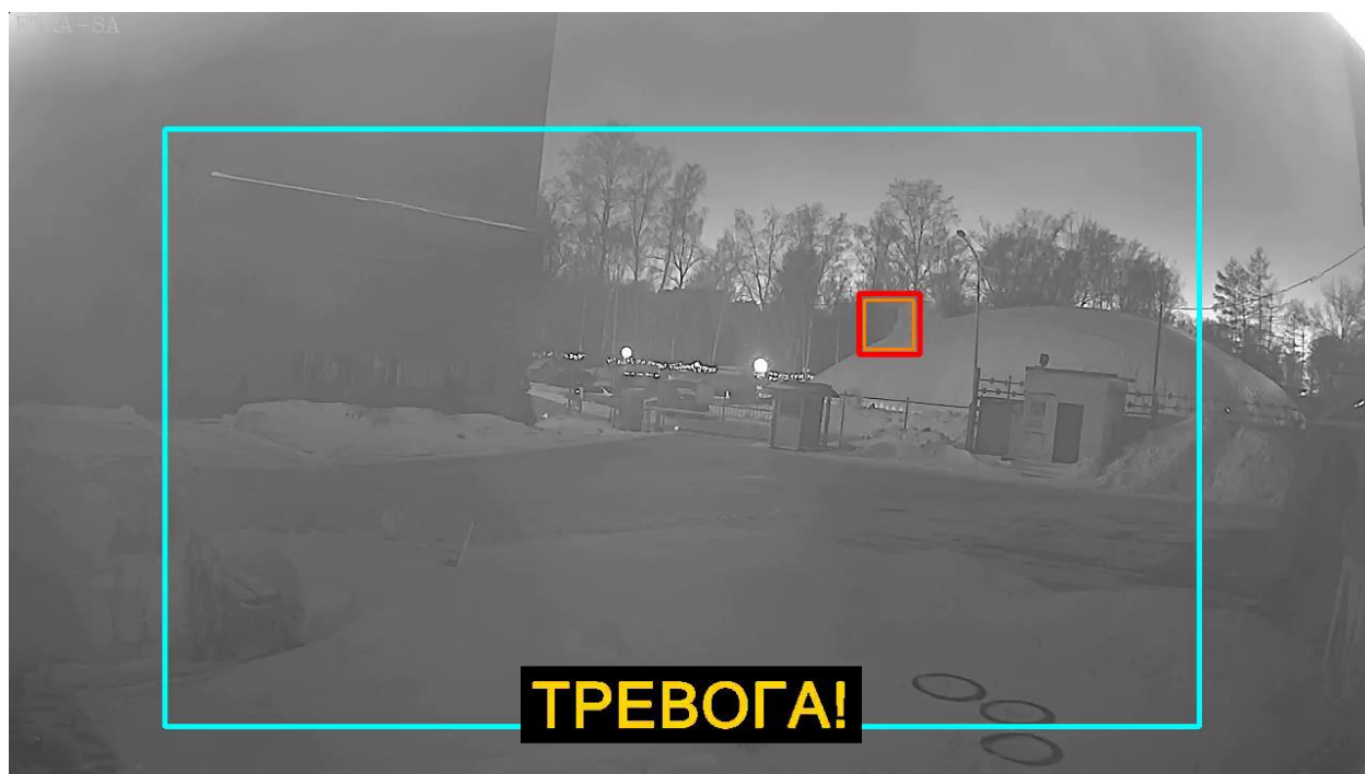
Рисунок 27 – 22 января 2024 года, 18:35. Включилась ИК-подсветка. При переключении камеры в ночной режим произошла потеря обнаруженного пожара, но по прошествии 2-х минут ИПВ проанализировал новый сложившийся фон и выделил на нём задымленную область.
