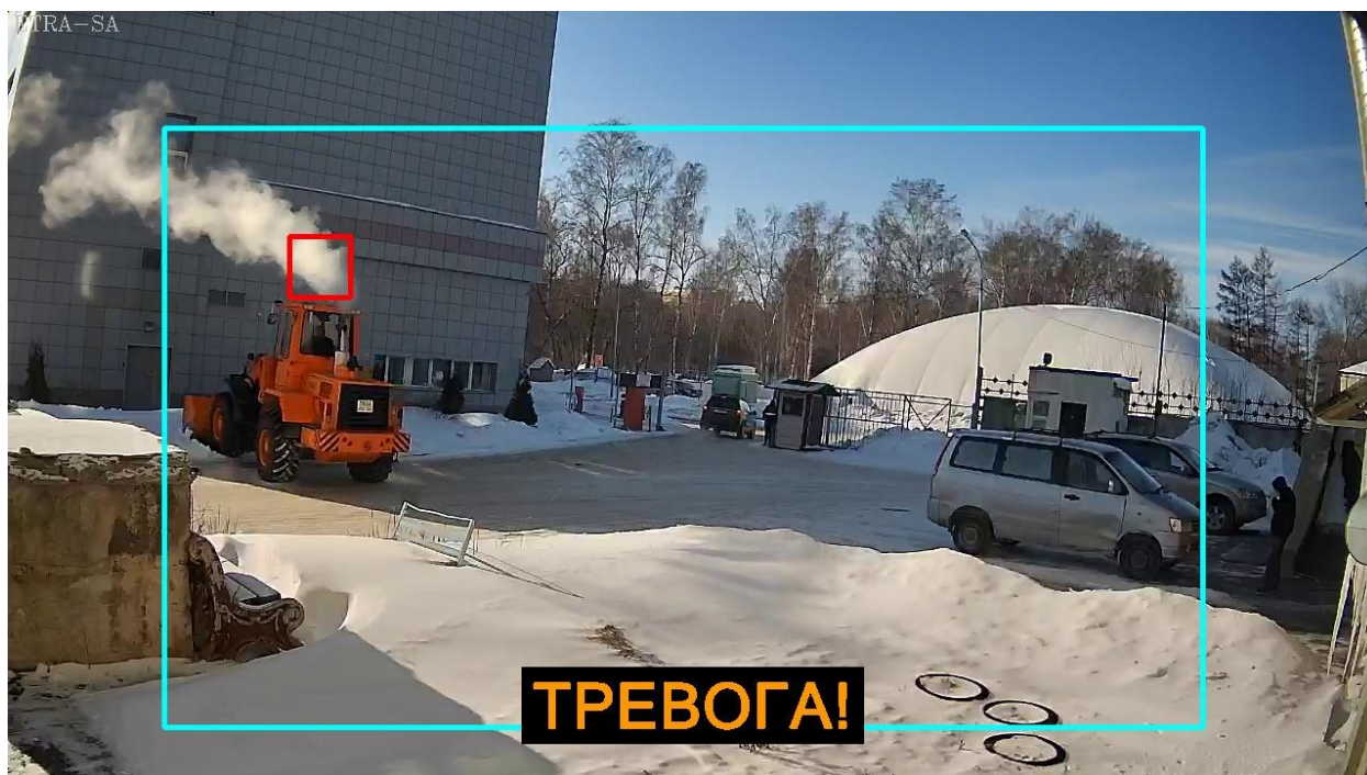
Рисунок 39 – Ложное срабатывание, вызванное штатным источником дыма.
