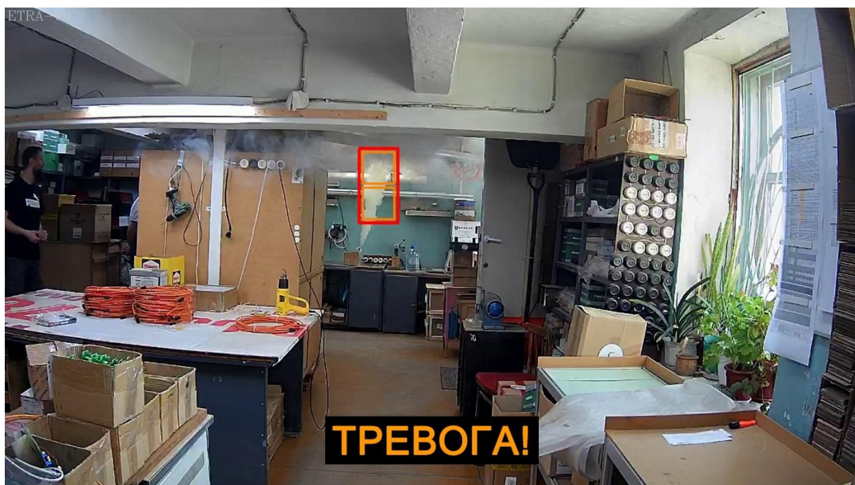
Рисунок 22 – Обнаружение пожара на расстоянии 7 метров.
