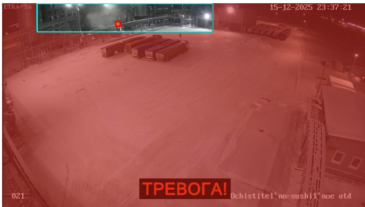
Рисунок 36 – Использование маскирования включающего признаки дыма, обнаруживаемых только внутри прямоугольника границ маски.
